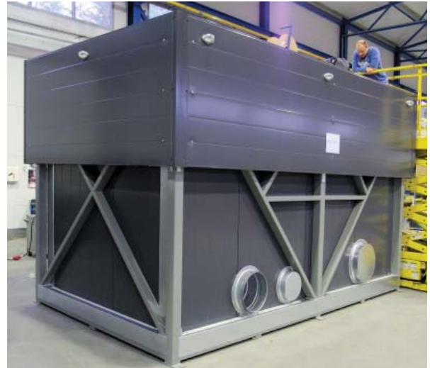
Kammio, korkeus 2,8 m odottamassa tiiviyskoetta.
